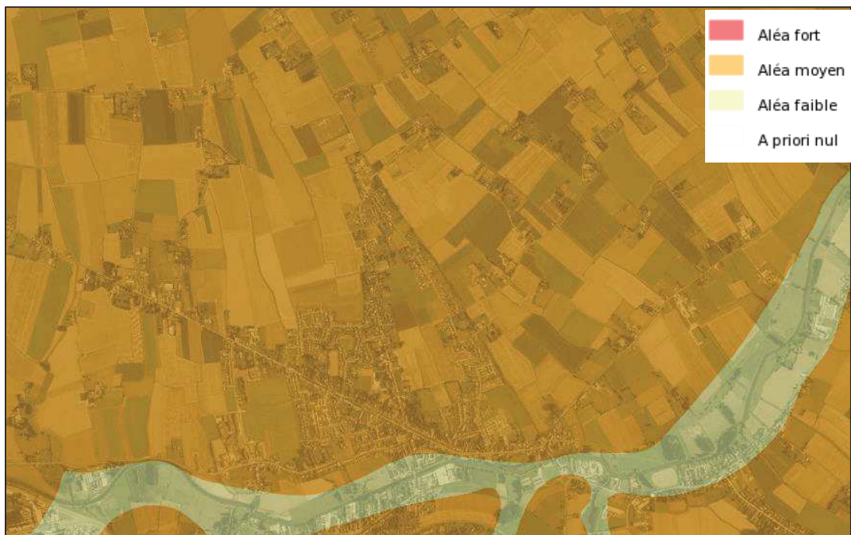
Figure 11: aléa retrait et gonflement des argiles (georisque.gouv)
